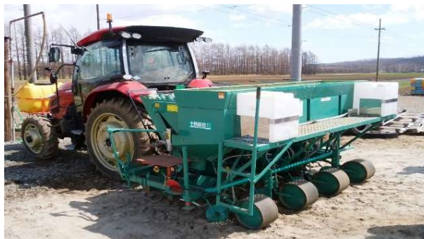
自動検出プログラム搭載の管理車両(6畦同時検出)
